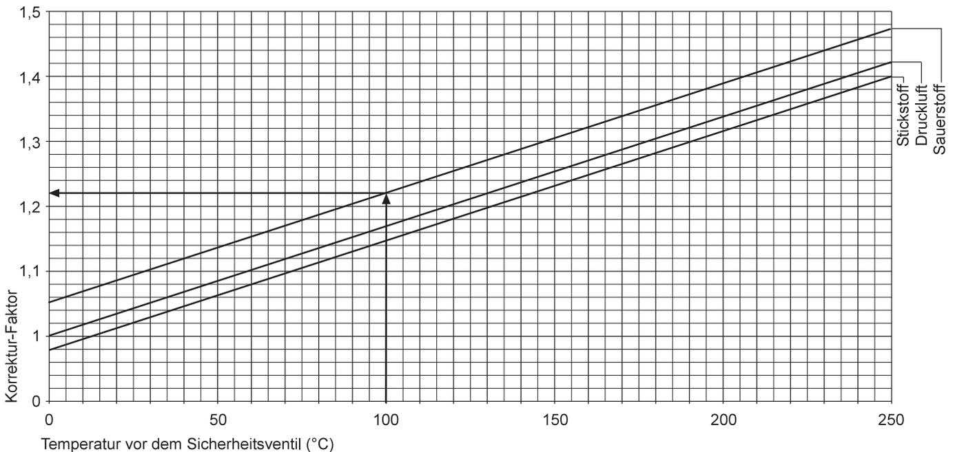
**Beispiel:** Für eine Leistung von 2000 m<sup>3</sup>/h Sauerstoff bei Atmosphärendruck von 1,013 bar und einer Temperatur von 100 °C ist ein Sicherheitsventil mit 10 bar Ansprechdruck zu bestimmen.
