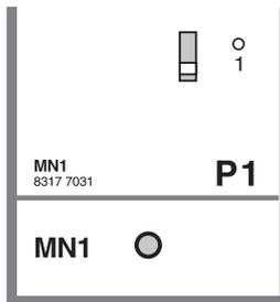
Das **Versorgungsmodul MN 1** (P1 = Position 1) erzeugt alle Spannungen, die der Regler benötigt.
