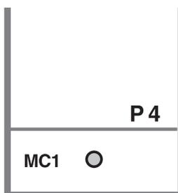
Das **Computermodul MC 1** (P4 = Position 4) enthält den zentralen Mikroprozessor, das komplette Regelprogramm und alle Daten des Regelgerätes. Dort laufen alle Informationen von Fühlern, Wählern und vom Bediengerät zusammen und werden verarbeitet.
