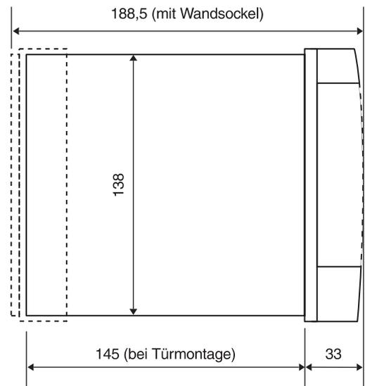
**separater Wandschalter für Bediengerät MCR 200-WK1**
