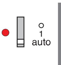
Nach abgeschlossener Überprüfung aller angesteuerten Stellmotoren und Pumpen, **alle Handschalter** an den Ausgangsmodulen MA1 und MA2 auf Stellung "auto" stellen.
