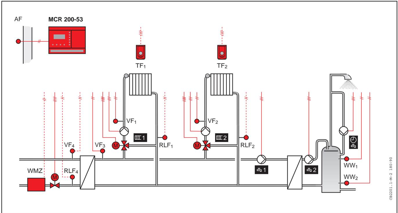
Heizungsregelung für Fernheizung mit zwei Radiatorenheizkreisen und Warmwasserbereitung mit Lade- und Zirkulationspumpe.
