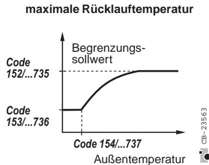
Der Fernheizregler MCR 200-53 besitzt eine Rücklauf Temperaturbegrenzung, sowohl für die gesamte Anlage, als auch für die einzelnen Mischkreise.
