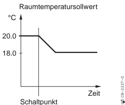
Ist der Endraumsollwert der Rampe (18 °C) erreicht, so sind beide Sollwerte gleich.
