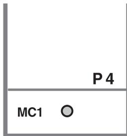
**Das Computermodul MC1** (P4 = Position 4) enthält den zentralen Mikroprozessor, das komplette Regelprogramm und alle Daten des Regelgerätes. Dort laufen alle Informationen von Fühlern, Wählern und vom Bediengerät zusammen und werden verarbeitet.
