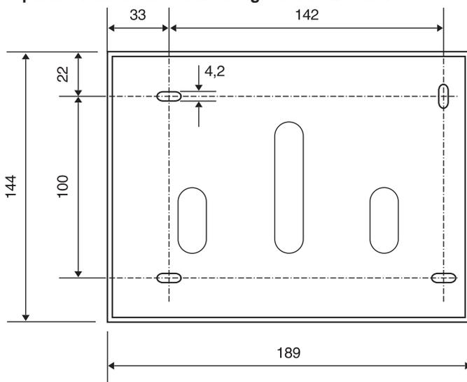
**separater Wandsockel (mit Bediengerät)**
