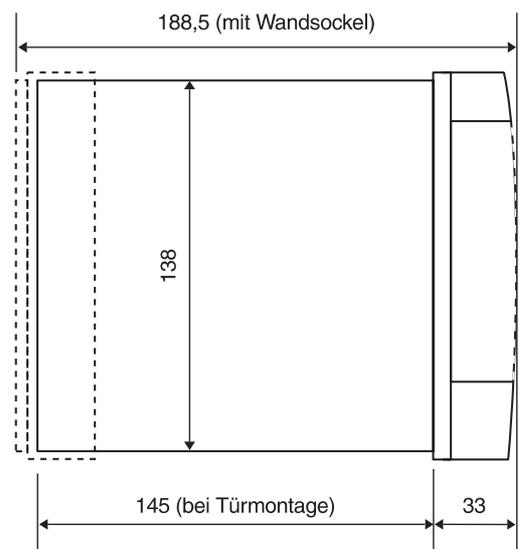
**separater Wandsockel für Bediengerät MCR 200-WK1**
