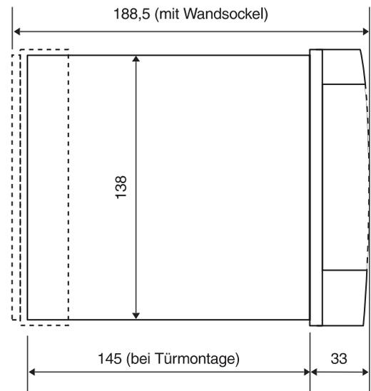
**separater Wandsockel für Bediengerät MCR 200-WK1**
