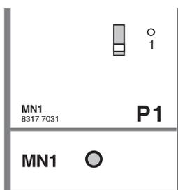
Das **Versorgungsmodul MN1** (P1 = Position 1) erzeugt alle Spannungen, die der Regler benötigt.
