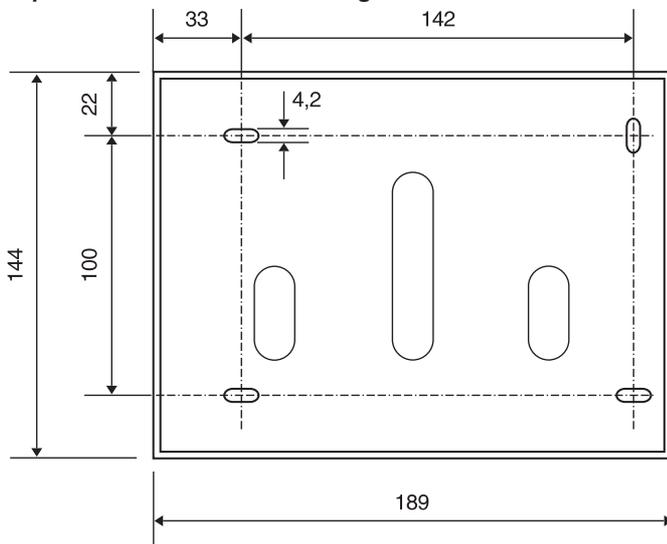
**separater Wandsockel (mit Bediengerät)**
