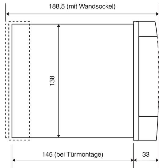
**separater Wandschalter für Bediengerät MCR 200-WK1**
