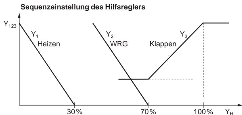
Die minimale Außenlufteinstellung für die Mischklappen erfolgt über **Code 1051, 1151.**
