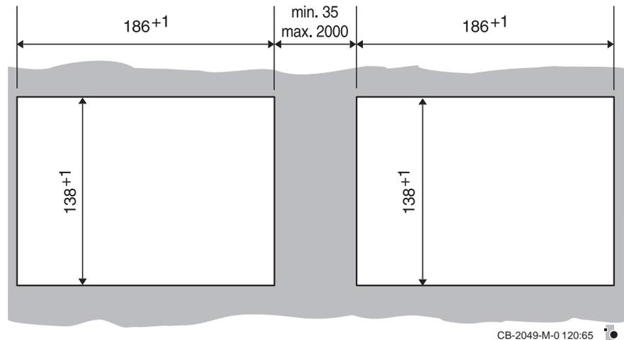
Soll ein MCR 200 mit einem Regelgerät MCR 52, MCR 32 oder MCR 200-GV2 verbunden werden, beachten Sie auch die Montageanleitung für diese Regelgeräte.
