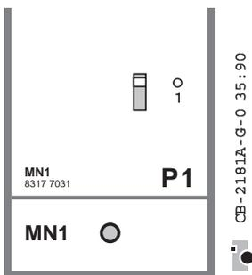
Das **Versorgungsmodul MN 1** (P1 = Position 1) erzeugt alle Spannungen, die der Regler benötigt. Auf dem Versorgungsmodul befindet sich der Betriebsschalter zum Ein- oder Ausschalten der Versorgungsspannung (niederspannungsseitig). Eine Leuchtdiode zeigt, daß die Arbeitsspannung für das Computermodul vorhanden ist.
