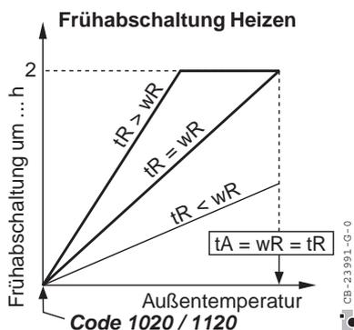
Der Korrekturfaktor ändert die Steigung der oben beschriebenen Kennlinie in Abhängigkeit von der Regeldifferenz:
