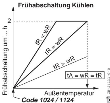
$$t_{VKA} = (120 \text{ min} + t_{Korr}) \cdot \frac{\text{Außentemperatur} - \text{Code 1024 / 1124}}{\text{Raumsollwert} - \text{Code 1024 / 1124}}$$
